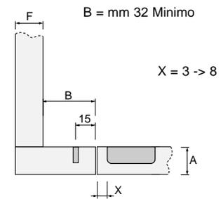
\* N.B.: per tale cerniera con montaggio in linea con il fianco (versione con asterisco) si applica la base con foratura 28 x 32 e codice **2478 012 050**
